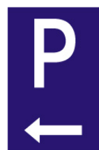
Π-31γ Κατεύθυνση προς χώρο επιτρεπόμενης στάθμευσης.
