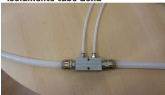
Διανομέας μετά τη σύνδεση των ρακορ και των σωλήνων PA12 8X1mm και PEX 20X2mm
